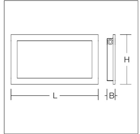
Luminaire pour la signalisation des voies d'évacuation. Corps en aluminium anodisé argent. Plaque display et technique de microlentille brevetée avec pictogramme de secours sur une face. Appareillage intégré. Système de batterie autonome avec auto-test automatique. Merci d'indiquer le numéro de motif du pictogramme de secours lors de la commande
