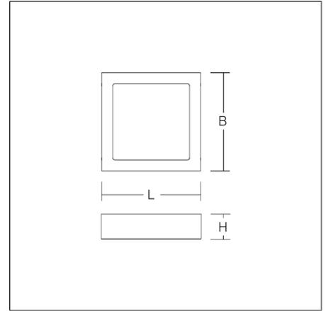
Downlight apparent ultra-plat. Boîtier apparent en tôle d'acier traité époxy. Plaque de recouvrement carrée en aluminium injecté traitée époxy. Guide de la lumière et diffuseur en plastique PMMA ne jaunissant pas, opalin mat. Convient à Montage des plafonniers, Flèche murale. Appareillage intégré.
