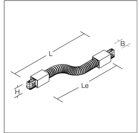
Flexible Kupplung, Kunststoff. Stufenlos  $\pm 180^\circ$  horizontal dreh- und vertikal schwenkbar.
