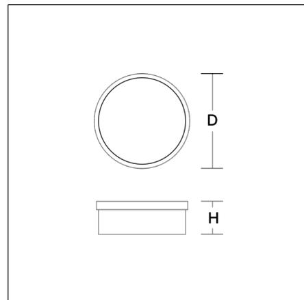
Luminaire apparent rond au design classique. Armature en matière synthétique. Diffuseur en matière synthétique (polypropylène) opalin mat satiné. Fixation du diffuseur par système de ressorts. Convient à Montage des plafonniers, Flèche murale. IP 43 montage au plafond, IP 44 montage mural.
