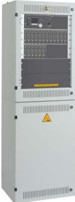
Sistema ad alimentazione centralizzata Multi per l'alimentazione delle lampade di sicurezza e di emergenza 230V/216V AC/DC conformemente a EN 50171, EN 50172, EN 50272-2, BGV A2 (VBG4) con monitoraggio integrato delle linee di uscita e singole lampade collegate alle linee senza ulteriori collegamenti di linee dati.
