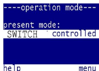
La modalità di funzionamento "in carica" o "attivato" può essere selezionata tramite il selettore frontale. Occorre selezionare l'opzione **interruttore (ricarica / attivo)**.
