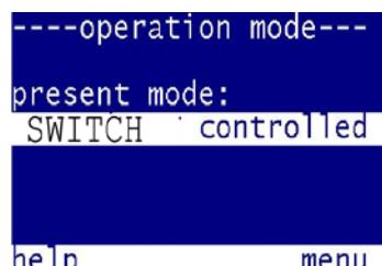
Driftläget “charging” eller “ready-to-operate” väljs enligt standard via den frontplacerade brytaren. Alternativet **SWITCH controlled** måste väljas.
