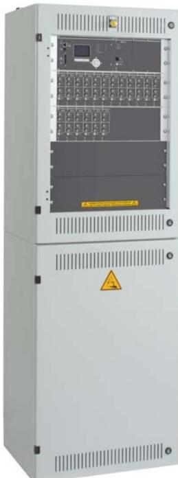
Det centrala batterisystemet MULTI för försörjning av säkerhets- och nädlägesarmatur med 230V/216V AC/DC i enlighet med EN 50171, EN 50172, EN 50272-2, BGV A2 (VBG4) med integrerad övervakning av oberoende armaturer och elektriska kretsar utan extra busslänk.
