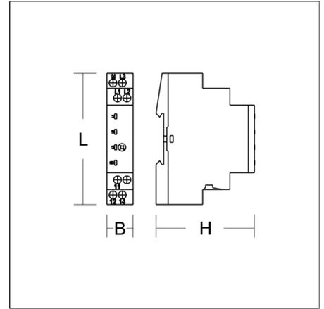
Relais de contrôle du réseau triphasé avec fonction de test. Convient à une utilisation dans des installations conformes à la norme DIN VDE0108. Pour encastrément dans des distributions secondaires afin de détecter les sous-tensions et pannes secteur dans un réseau à 1 phase ou à courant triphasé avec une largeur totale de 18 mm. Avec fonction de test et LED d'état pour chaque phase d'entrée.
