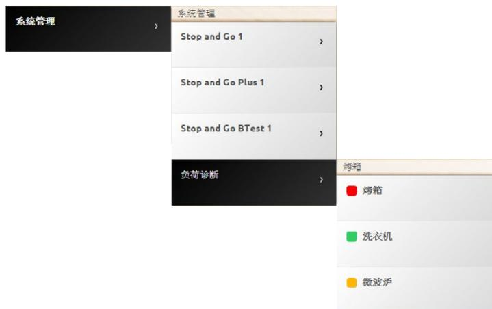
图标 ■ 说明负荷工作正常；图标 ■ 说明负荷工作正常，但差动电流接近规定限制；图标 ■ 说明差动电流超出规定限制，导致漏电保护开关打开。
