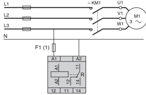
(1) 1 A quick-blowing fuse, circuit breaker or circuit protector (US) / Fusible ultra rapide 1 A ou coupe circuit / Gerätesicherung 1 A Superflink oder Geräteschutzsicherung / Fusible ultra rápido 1 A o interruptor de circuito / Ultrasnelle zekering 1 A of schakelaar
