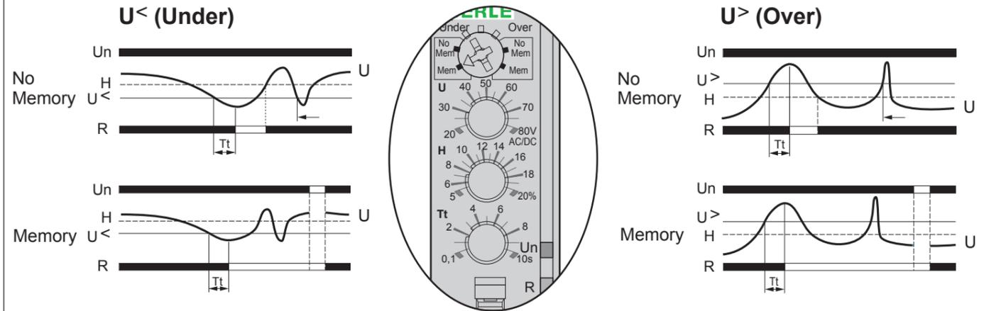
Tt: time delay on opening, after threshold overshoot (adjustable on front panel) / Tt: temporisation à l'ouverture après franchissement du seuil (réglable en façade) / Tt: Verzögerung beim Öffnen nach Überschreitung des Grenzwerts (an Frontseite einstellbar) / Tt: temporización en la apertura luego del paso de umbral (ajustable en fachada) / Tt: tijdgestuurde regeling bij de opening na het overschrijden van de drempel (instelbaar op het voorpaneel)
