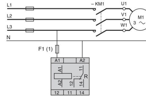
(1) 1 A quick-blowing fuse, circuit breaker or circuit protector (US) / Fusible ultra rapide 1 A ou coupe circuit / Gerätesicherung 1 A Superflink oder Geräteschutzsicherung / Fusible ultra rapido 1 A o interruptor de circuito / Ultrasnelle zekering 1 A of schakelaar
