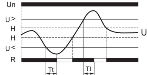
Tt: time delay on opening, after threshold overshoot (adjustable on front panel) / Tt: temporisation à l'ouverture après franchissement du seuil (réglable en façade) / Tt: Verzögerung beim Öffnen nach Überschreitung des Grenzwerts (an Frontseite einstellbar) / Tt: temporización en la apertura luego del paso de umbral (ajustable en fachada) / Tt: tijdgestuurde regeling bij de opening na het overschrijden van de drempel (instelbaar op het voorpaneel)
