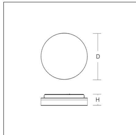
Decken- und Wandleuchte im minimalistischen Design. Gehäuse Kunststoff (Polycarbonat). Diffusor Kunststoff (Polycarbonat) opal. Gehäuse und Diffusor fest verbunden. MultiColour: Farbtemperatur mit Schaltelement einstellbar. Auswahlmöglichkeit 3000 K oder 4000 K. Werkseitig auf 3000 K eingestellt. Schnellmontageadapter Stahlblech verzinkt, mit Befestigungsschrauben. Betriebsgerät integriert.
