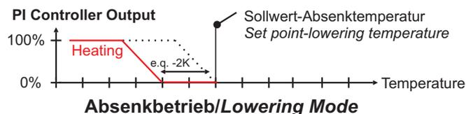
Die Umschaltung erfolgt beim SR04P MS durch den Schiebeschalter (Stellung 1 = Absenkbetrieb, Stellung 0 = Komfortbetrieb).
