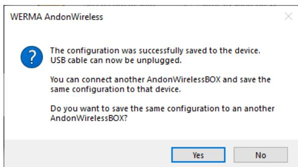
4. Cliquez sur **Yes** pour transférer la configuration actuelle vers d'autres Andon WirelessBOXes, voir «*Transfert de la configuration vers d'autres Andon WirelessBOXes*», p. 98.
