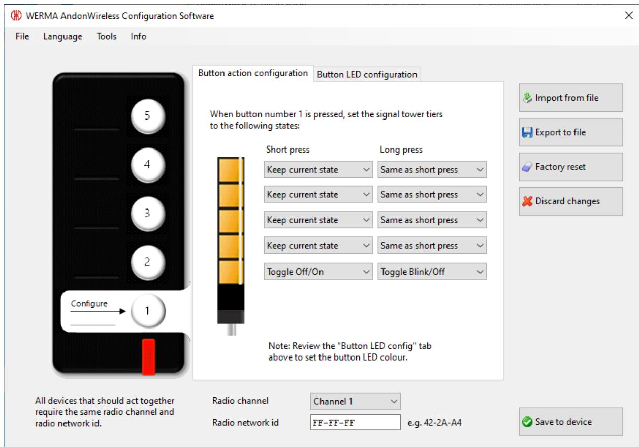
3. Cliquez sur **Save to device** pour transférer la configuration vers l'Andon WirelessBOX.
