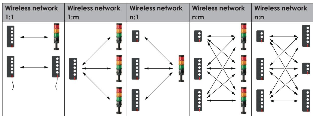
Les Andon WirelessBOXes à 2 ou 5 boutons peuvent être utilisés ensemble dans un réseau sans fil. Les Andon WirelessBOXes peuvent également avoir des configurations de boutons différentes.
