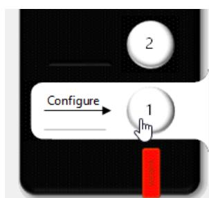
2. Pour chaque étage de la colonne lumineuse, sélectionnez l'état après une brève pression sur le bouton (pression courte) et après une pression plus longue (pression longue).
