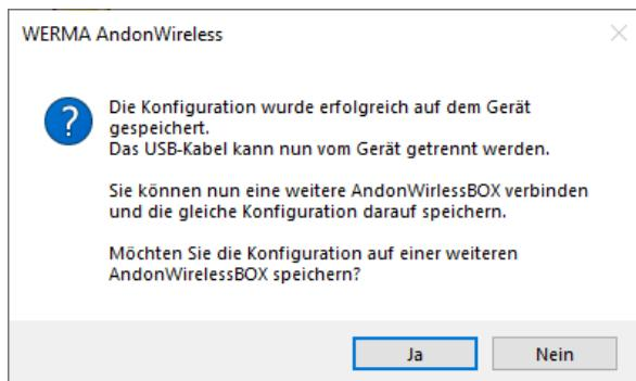
4. Auf **Ja** klicken, um die aktuelle Konfiguration auf weitere Andon WirelessBOXen zu übertragen, siehe "Konfiguration auf weitere Andon WirelessBOX übertragen", S. 22.
