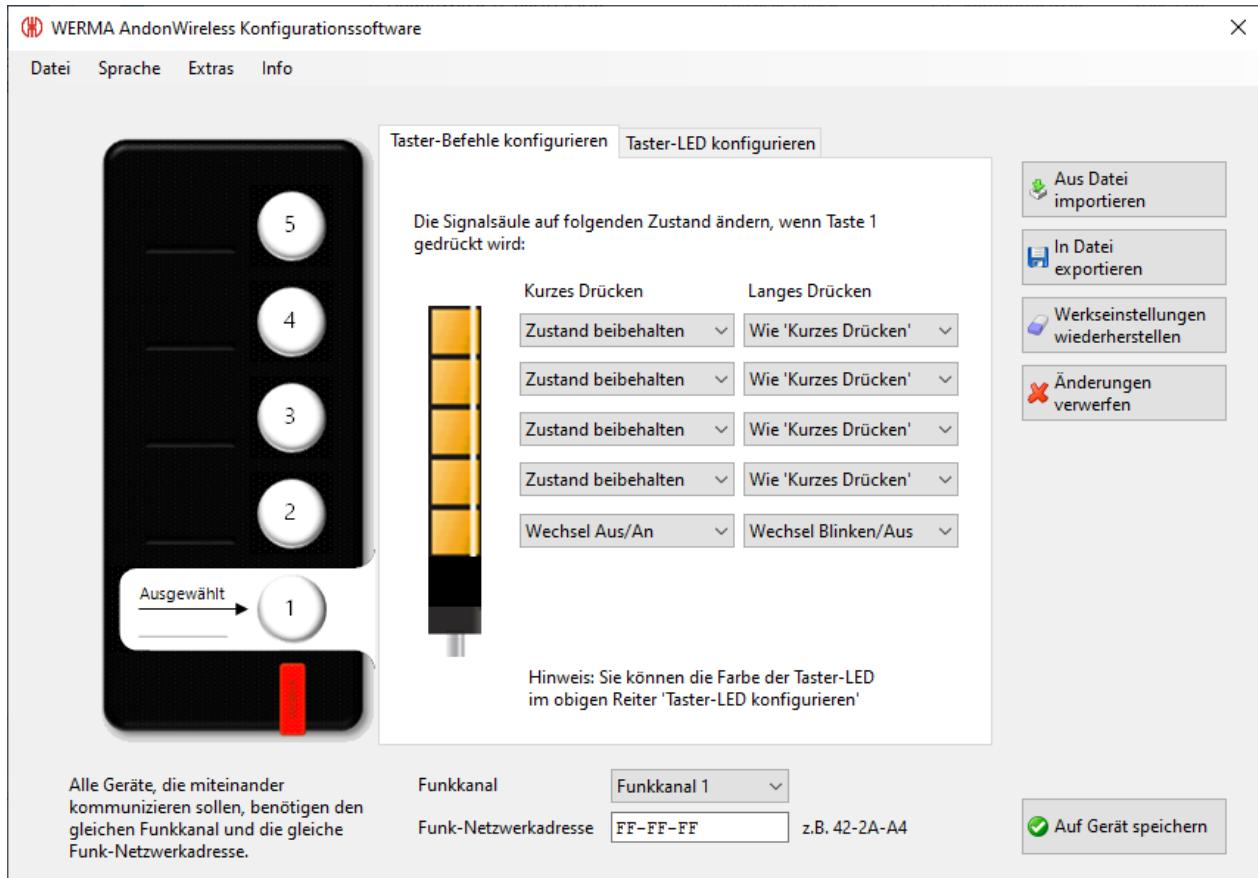
3. Auf **Auf Gerät speichern** klicken, um die Konfiguration auf die Andon WirelessBOX zu übertragen.
