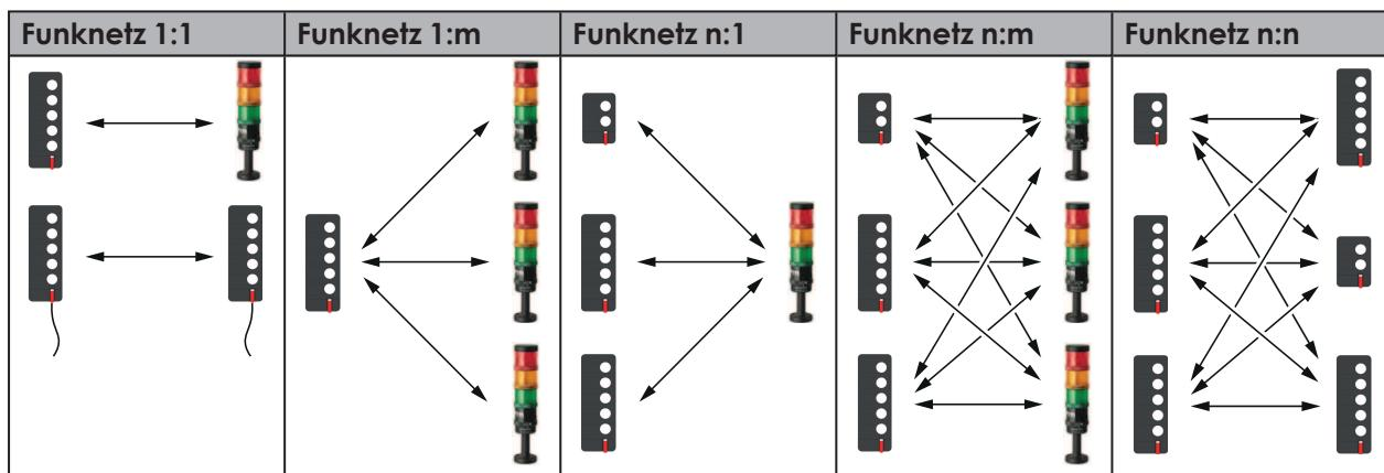
Andon WirelessBOXen mit 2 oder 5 Tasten können gemeinsam im Funknetz genutzt werden. Dabei können die Andon WirelessBOXen auch unterschiedliche Tastenkonfigurationen aufweisen.
