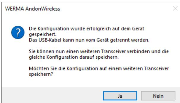
4. Auf **Ja** klicken, um die aktuelle Konfiguration auf weitere Transceiver zu übertragen, siehe "Konfiguration auf weitere Transceiver übertragen", S. 28.
