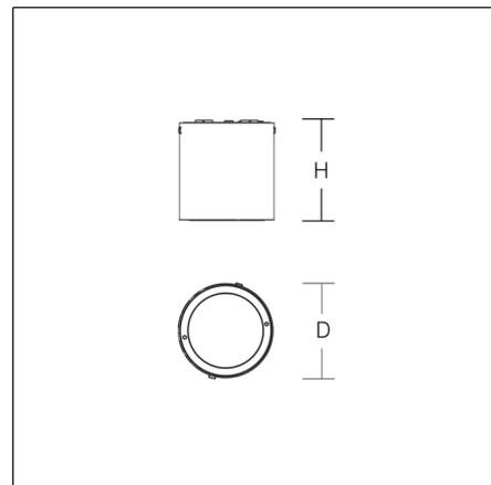
Downlight apparent rond pour l'extérieur. Corps en aluminium injecté traité époxy. Diffuseur en verre transparent. Appareillage intégré.
