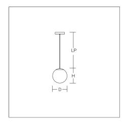
Luminaria de montaje en suspensión, con un diseño esférico atemporal. Base de metal cromado. Dosel: metal cromado. Difusor de material sintético opalino satinado mate (polietileno), resistente a golpes. Iluminación homogénea y suave sin sombras. Incluido placa de montaje con terminal y material de fijación para la tija de suspensión. No incluye tija de suspensión, que ha de solicitarse por separado.
