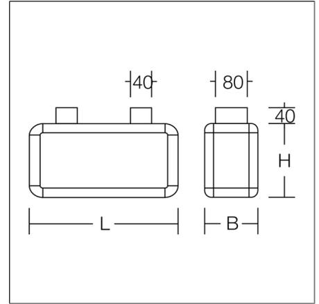
Luminaria rectangular de montaje en superficie con diseño clásico. Para señalización de vías de evacuación. Carcasa de aluminio con uniones de esquina de material sintético. Difusores de material sintético opalino con símbolo gráfico de evacuación a una o dos caras. Equipo incluido. Sistema de emergencia autónoma con autotest. Número de artículo del motivo a especificar en el pedido!
