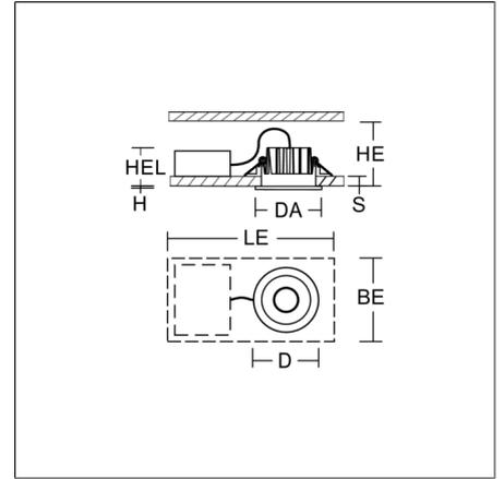
Luminaire de secours rond pour l'éclairage des sorties de secours. Avec optiques à lentilles pour l'éclairage des issues de secours. Convient pour le raccordement à l'alimentation centrale en électricité de secours. Avec l'anneau de fixation au plafond séparé inclus, convient également aux découpes de plafond de Ø 68 mm.
