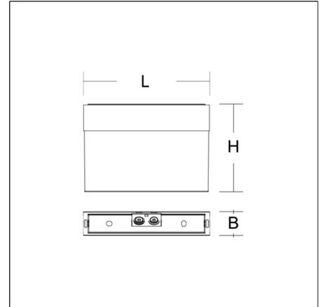
Luminaire pour marquage de voies de secours avec batterie autonome intégrée Corps matière synthétique (polycarbonate), résistant aux chocs. 4 feuilles de pictogrammes de secours et 1 feuille blanche à apposer sur le diffuseur transparent incluses. Équerre de fixation pour le montage mural et deux vis d'étanchéité également fournies. Système de batterie autonome avec auto-test automatique.
