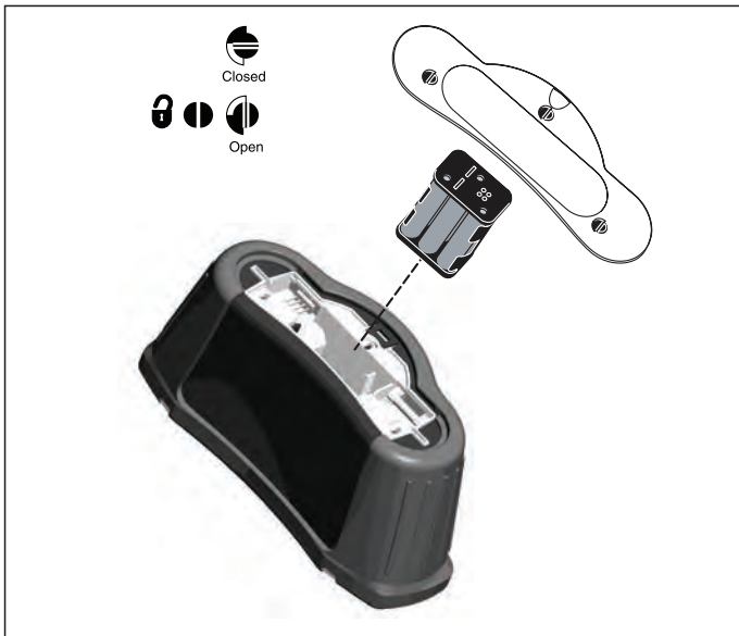
Figura 24. Sostituzione delle batterie
