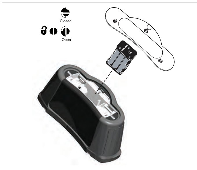
Figure 24. Remplacement des piles
