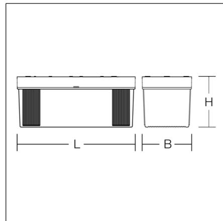
Luminaire en matière synthétique, version résistante aux chocs. Pour marquage de voies de secours. Armature en matière synthétique (polycarbonate). Diffuseur en matière synthétique (polycarbonate) opalin. Convient à Montage des plafonniers, Flèche murale. Avec accessoires également possible sous forme de luminaire suspendu. Système de batterie autonome avec auto-test automatique. 4 feuilles de signalisation des sorties de secours fournies.
