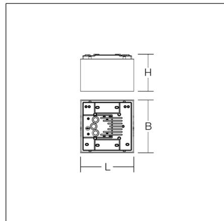
Luminaire pour la signalisation des voies d'évacuation. Armature en aluminium injecté traité époxy Diffuseur en matière synthétique (PMMA) opalin. 4 films pour marquage de voies de secours fournis (ISO 7010). Appareillage intégré. Convient pour le raccordement à l'alimentation centrale en électricité de secours. Transformation en luminaire suspendu possible au moyen d'accessoires.
