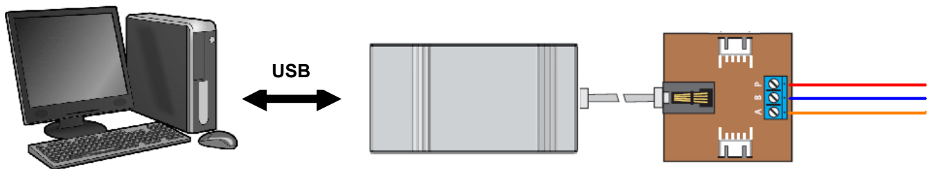
Fig.1: aansluitschema voor het koppelen van de interface op de bus ('a', 'b' en 'P')
